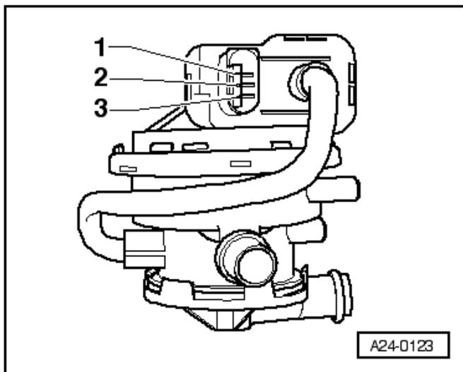
Диагностический насос топливной системы -V144 расположен в задней левой колесной нише под подкрылком.
