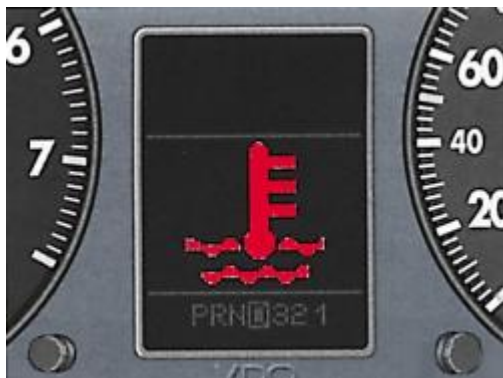
Рис. 1.74. Индикация перегрева или падения уровня охлаждающей жидкости в системе охлаждения (красный символ)
