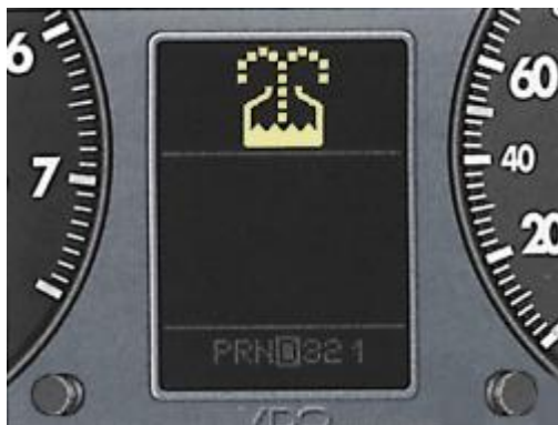
Рис. 1.75. Индикация падения ниже нормы уровня жидкости в бачке стеклоомывателя (желтый символ)
