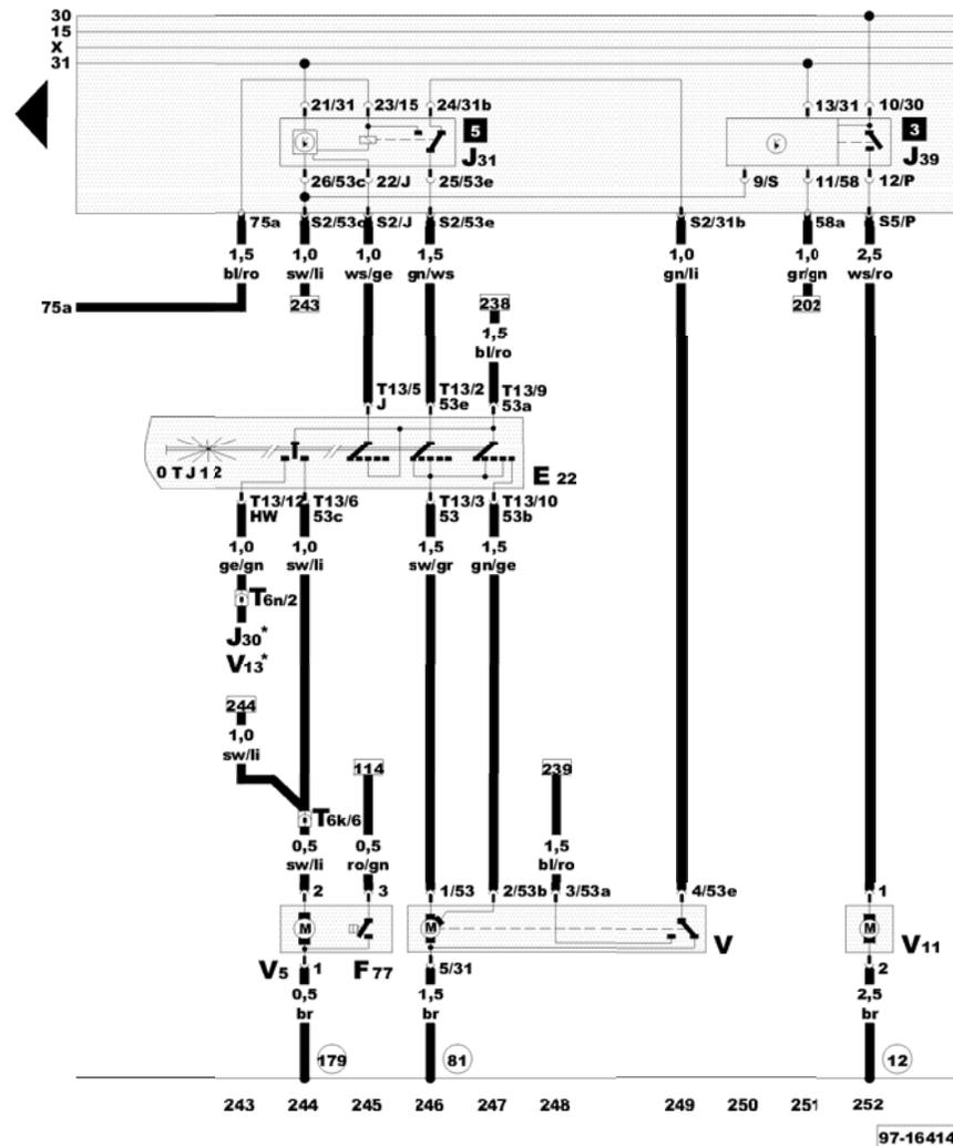
**Scheibenwischerschalter für Intervallbetrieb, Scheibenwisch- und -waschanlage, Scheinwerferreinigungsanlage**
